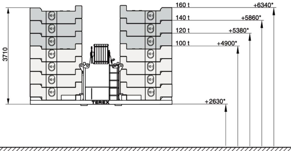
\* Tail swing above ground · Durchschwenkhöhe über Boden · Giration AR au-dessus du sol · Oscillazione posteriore sul livello del suolo · Radio de giro trasero sobre el suelo · Giro da traseira acima do solo · Вынос хвостовой части над поверхностью
