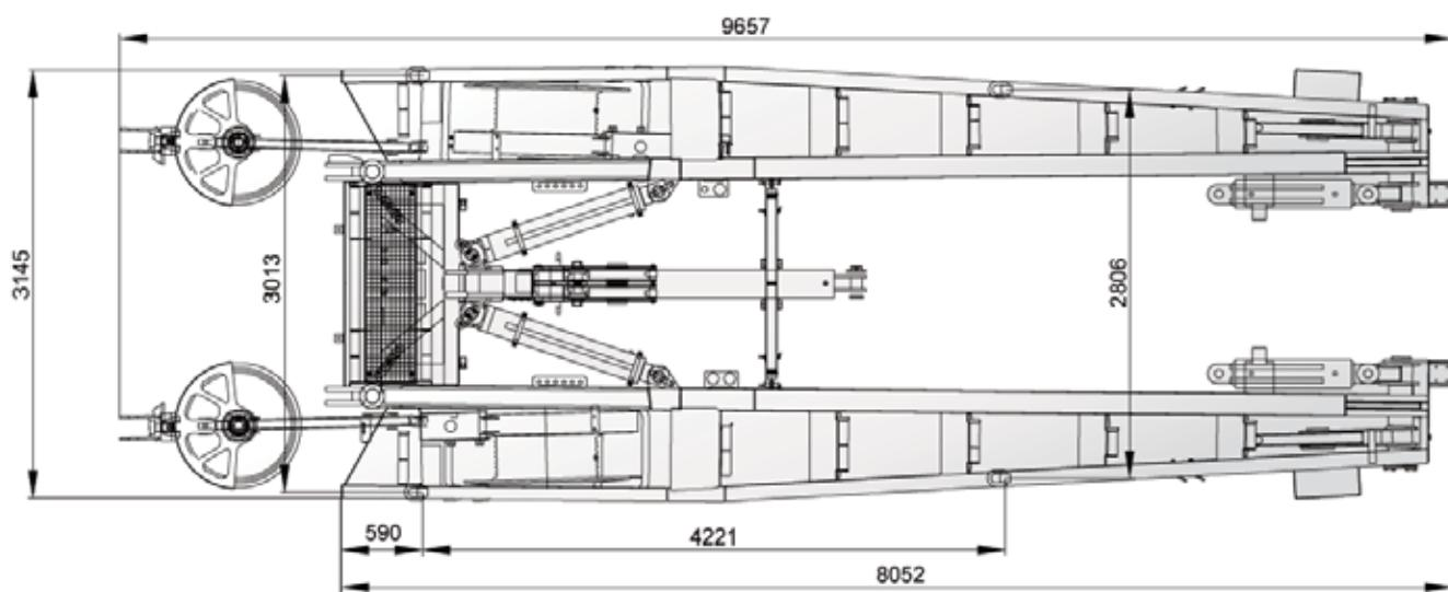
Outriggers · Abstützungen · Calage · Stabilizzatori · Estabilizadores · Estabilizadores · Выдвижные опоры
