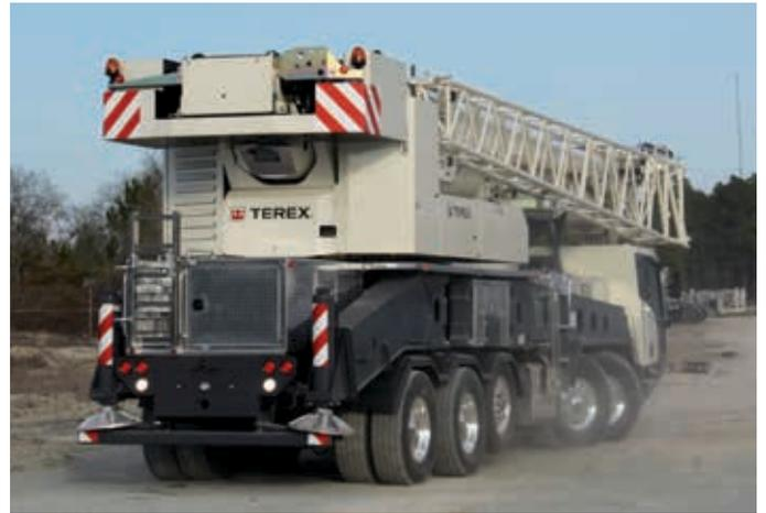
El estado de la carretera o del lugar de trabajo nunca es ideal. Terex lo sabe y por eso ha diseñado un sistema de suspensión neumático y resistente para suavizar las duras condiciones del camino y mantener la fiabilidad metro a metro.
