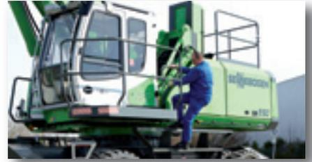
Gute Zugänglichkeit zu allen Maschinenkomponenten und Wartungspunkten
