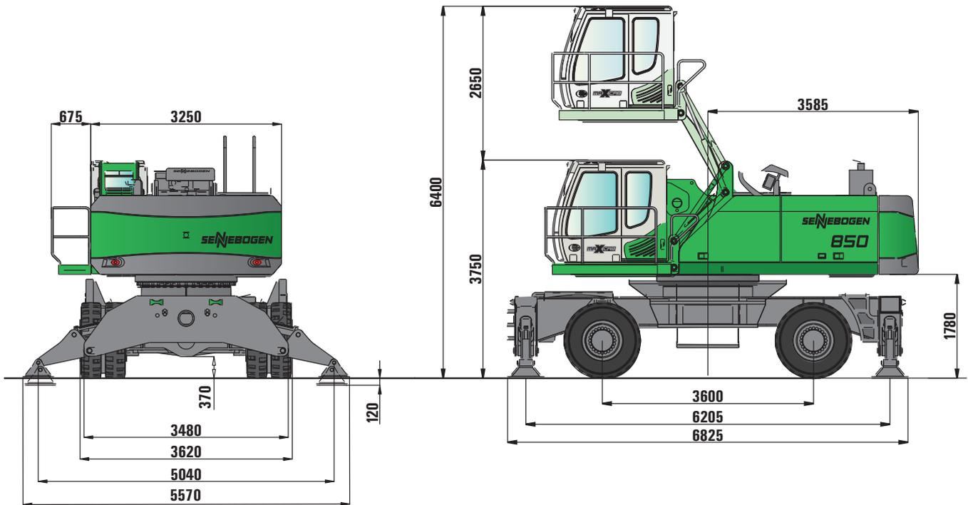
850 M mit hydraulisch hoch- und vorfahrbarer maXcab Typ D 300/260, Bereifung 14.00-24, 8-fach, Transportbreite 3620 mm
