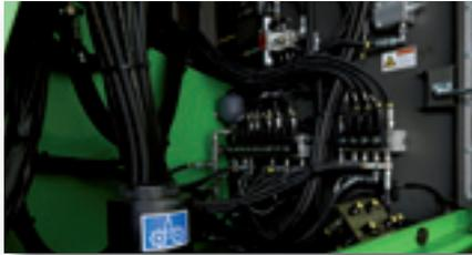
Zentrale Messpunkte zur einfachen und schnellen Überprüfung der gesamten Hydraulikanlage
