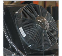
Heat exchanger. Cambiador de calor.
