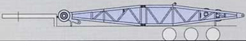
Top and root section lower luffing mast / Spitze und Fuß Wippstütze unten / Pointe et pied de contre-flèche inférieure
