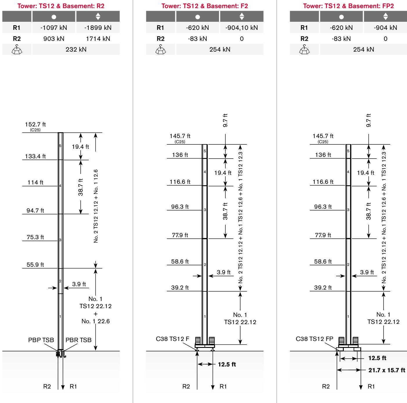
Max. under hook height • Höchste Hakenhöhe • Hauteur maxi. sous crochet • Maxima altura bajo gancho • Altezza max. sotto gancio
