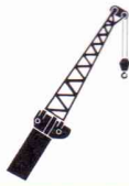
■ 40mブーム+10.5mスーパーラフィングブーム+11mベースジブ (A性能)
