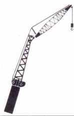
■ 40mブーム+10.5mスーパーラフティングブーム+11mベースジブ+15mラフティングジブ (A性能)
