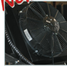
Heat exchanger. Cambiador de calor.
