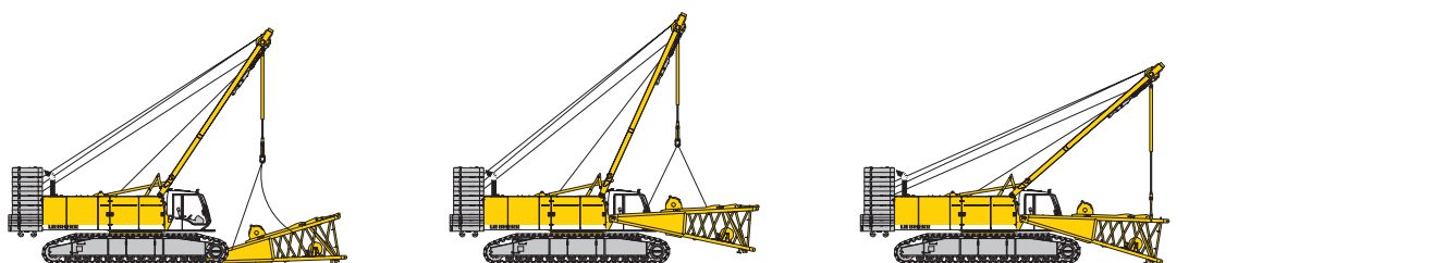
Entladung und Anbau des Auslegeranlenkstückes
